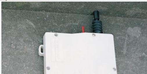
Photo du haut: X-Trigger surveillant les largeurs de fissures, câblé; photo en bas à gauche: X-Trigger servant d'alarme en veille; photo en bas à droite: X-Trigger faisant office de palpeur.
