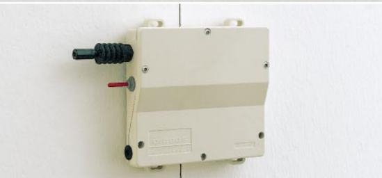
Photo du haut: X-Trigger surveillant les largeurs de fissures, câblé; photo en bas à gauche: X-Trigger servant d'alarme en veille; photo en bas à droite: X-Trigger faisant office de palpeur.
