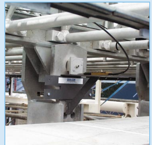
Extensomètre servant de palpeur sur une construction métallique.
